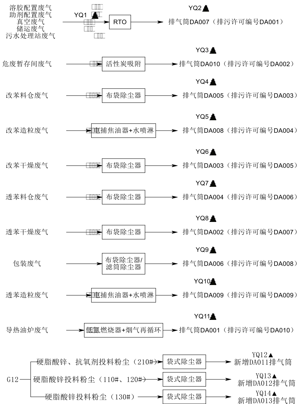
图 4.2-1 有组织废气处理工艺流程示意图
